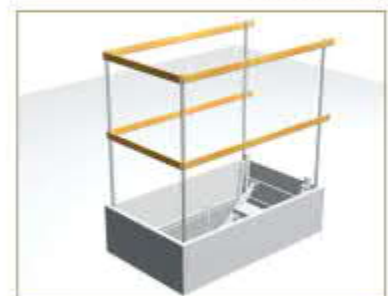
Lukenumwehrung aus Holz mit Stahlstützen (baurechtlich vorgeschrieben)
